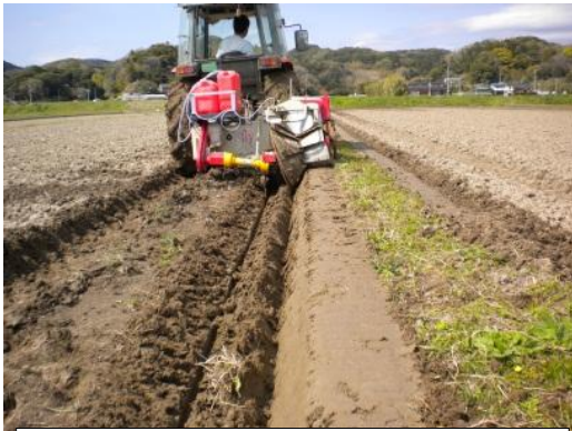
あぜを塗る機械が登場。トラクターに取り付け、三反(900坪)の周囲を20分ほどで仕上げる。
