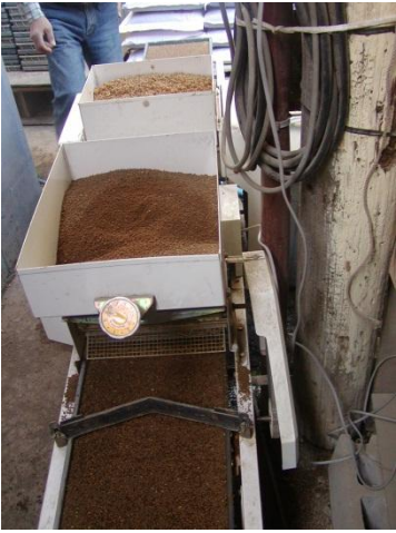
育苗箱に均等にモミを蒔き、その上に土をかけ、さらに水を撒く機械。電気モーターで作動。
