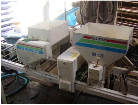
育苗箱に均等にモミを蒔き、その上に土をかけ、さらに水を撒く機械。電気モーターで作動。
